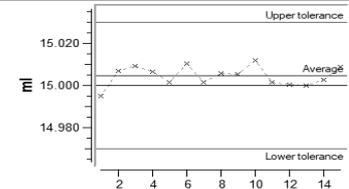
Diese Angaben sind Endprüfwerte bezogen auf 20°C, d.h. gleiche Temperatur von Gerät und Umgebung und Flüssigkeit (aqua dest.). Die Prüfung erfolgte gemäß ISO 648.
